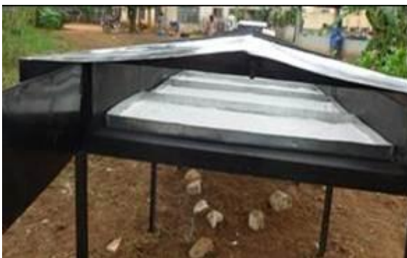
Figure 4: Séchoir hybride (solaire ou à gaz)
